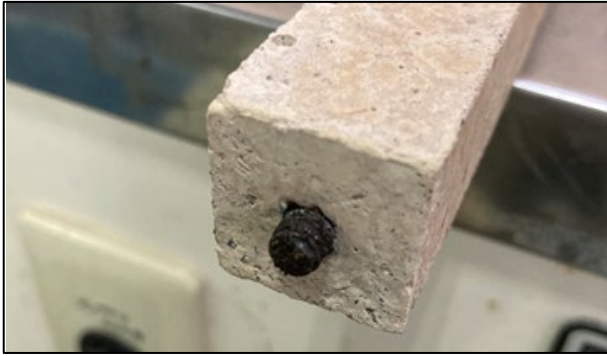
図－２ ステンレスプラグの腐食状況
