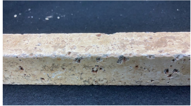
図－３ ポップアウトの発生状況（IS50）
