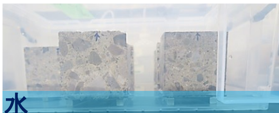
図-5 一面浸漬試験の概念図
