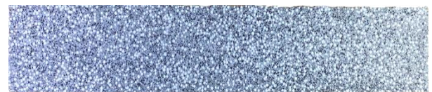
写真-1 供試体断面(分散)
