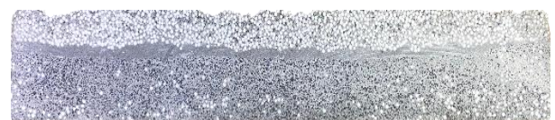
写真-3 供試体断面(2層に分離)
