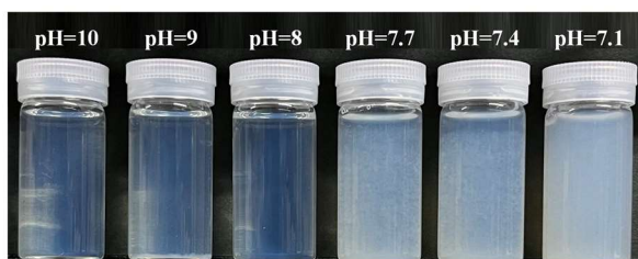
図-5 CS50%の pH 変化による分散・凝集の様子
