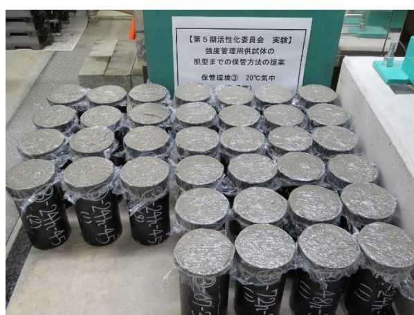
写真－4 保管状況（20℃気中）
