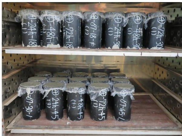
写真-5 保管状況 (35℃気中)
