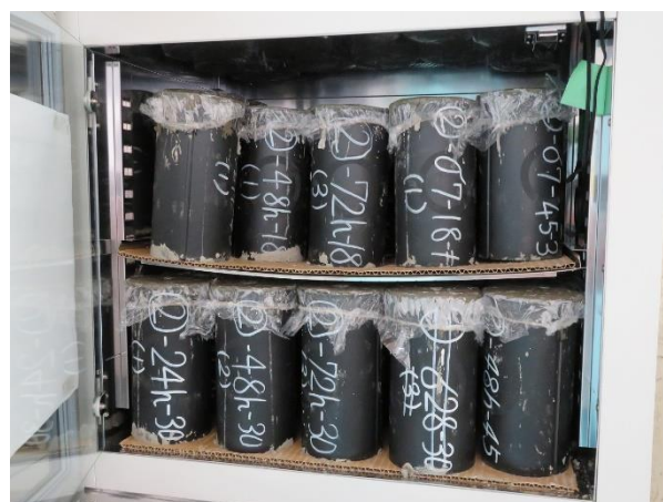
写真－3 保管状況（5℃気中）
