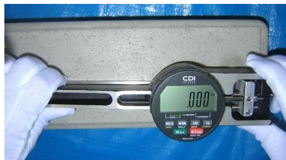
写真-1 基準標尺による0設定
