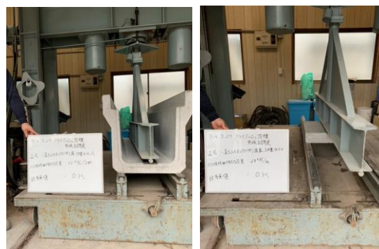
写真-6 PCa製品の曲げ試験状況
