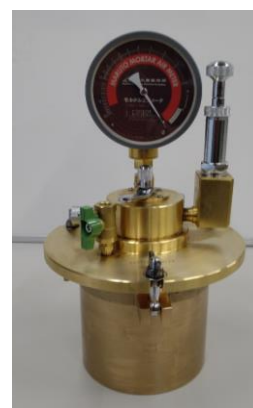
写真-2 モルタルエアメータの外観
