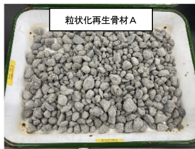
写真-3 養生終了後の各粒状化再生骨材
