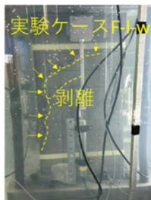
図-12 かぶりコンクリートの剥離
