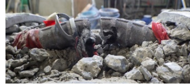
【D-2, 破壊状況 (上縁引張側の鉄筋破断)】
