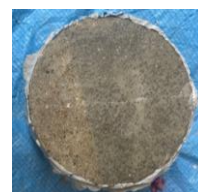
写真-2 補修後の試験体の状況の一例 (M1-A)
