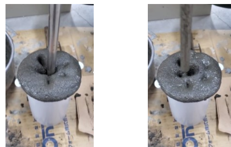
突き棒を突いた状態 突き棒を抜いた状態 (b) 古紙2%置換ジオポリマーモルタル(#3)
