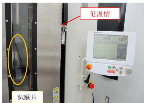
写真-3 低温環境での引張試験状況
