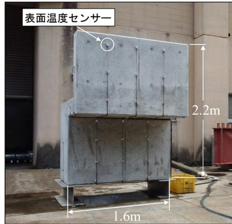
図-2 鉄筋コンクリート製模型
