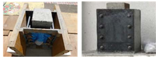
(a)補強型枠設置状況
