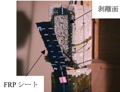
図-11 付着試験の剥離の様子
