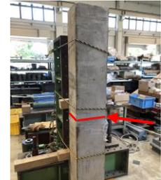
写真-3 継手あり供試体接合状況
