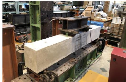
写真-5 載荷試験の様子
