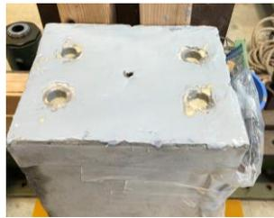
写真-1 接合面エポキシ樹脂材塗布状況
