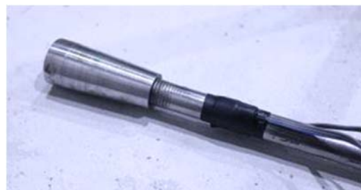
図-1 テーパーナットアンカー
