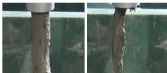
(a) 正常押出状態 (b) ノズルが閉塞する寸前
