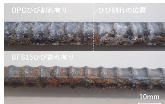
図－10 鉄筋の腐食状況 (Type A 供試体)
