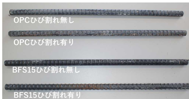
図－10 鉄筋の腐食状況 (Type A 供試体)
