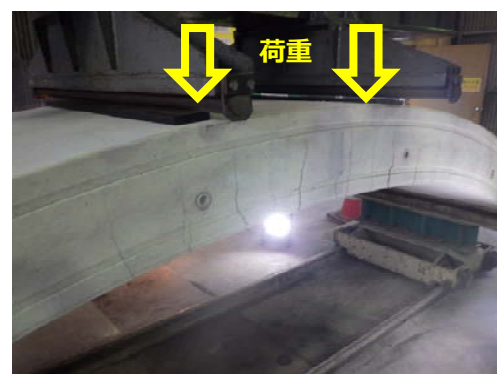
写真-5 実大セグメントの曲げ試験状況
