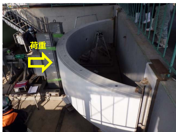
写真-6 実大セグメントの継手曲げ試験状況
