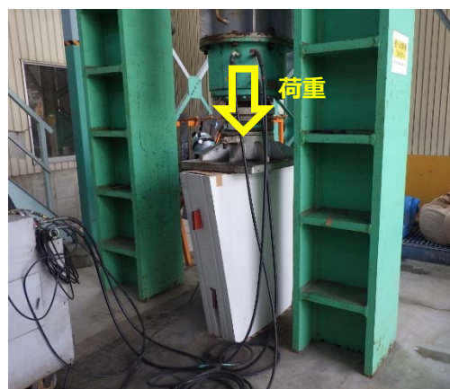
写真-7 実大セグメントのジャッキ推力試験状況
