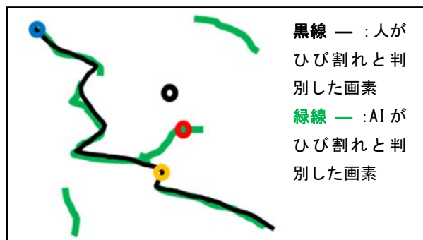
図-2 AIによるひび割れ自動検出におけるTP/FP/TN/FNの概念図
