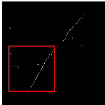
c) 開発した AI によるひび割れ画像
