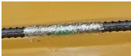
写真-1 付着切れ模擬方法（付着切れ長さ 150mm）
