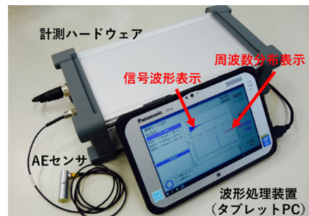
図-1 デジタル打音検査装置
