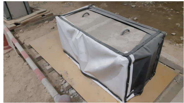
写真-5 角柱供試体の養生の状況
