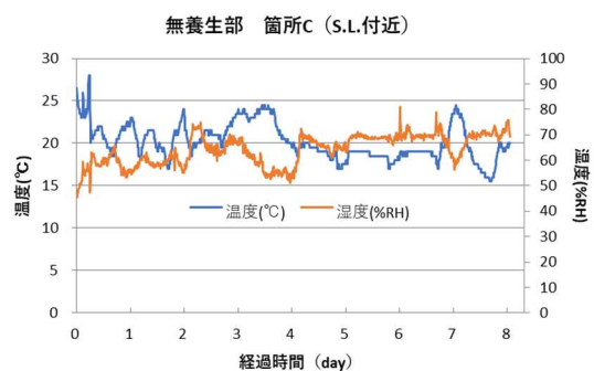
図-9 No.16ブロックの無養生部の温湿度の計測結果（箇所C、S.L.付近）
