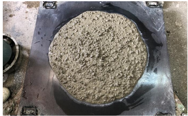
写真-1 スランプフローの試験状況
