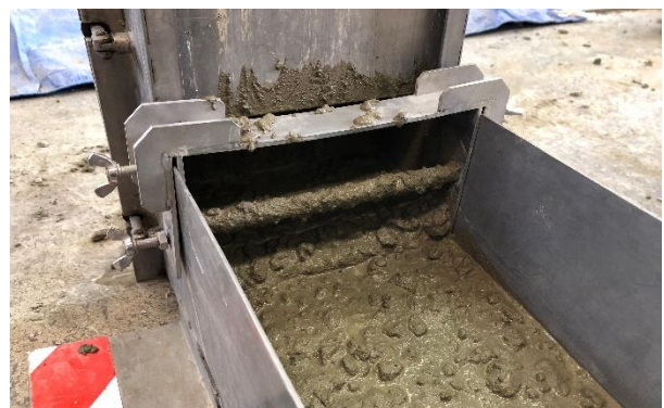
写真-3 障害あり L フローの試験状況
