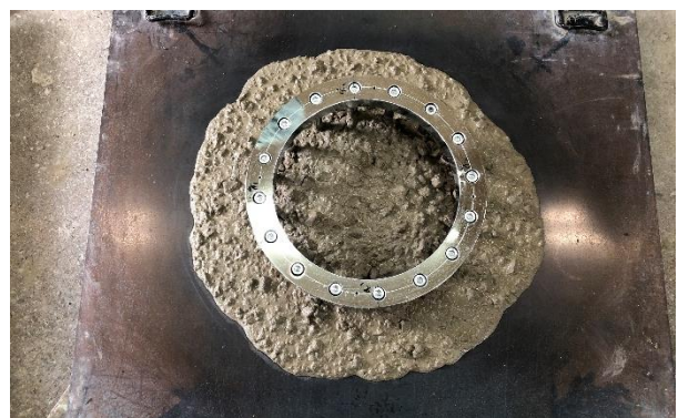
写真-2 Jリングフローの試験状況
