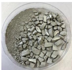
写真-2 比表面積の測定試料
