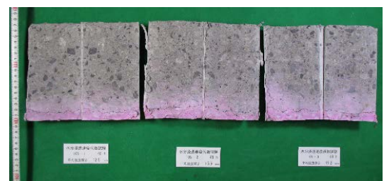
(c) 空気量 10% 浸透深さ 14.4mm
