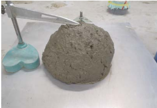
(a) W=165kg/m 3 s/a=51% W/C=55% 練上がり 30 分後：スランプ 14.5cm 空気量 4.9%
