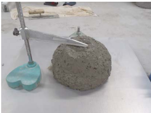
(b) W=130kg/m 3 s/a=41% W/C=38% 練上がり 30 分後：スランプ 14.0cm 空気量 11.5% 写真－1 スランプの状況
