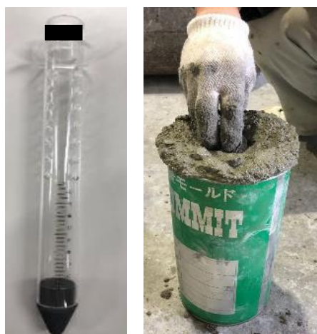
図-1 円筒貫入試験状況
