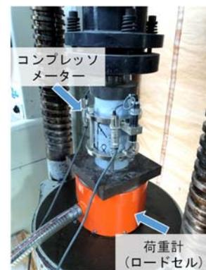
写真-1 圧縮強度試験の様子
