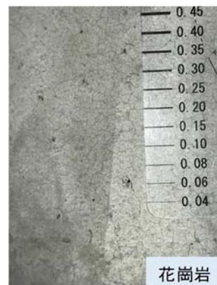
写真-3 加熱後のひび割れの様子
