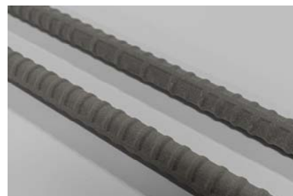
写真-1 PVB-S 被覆鉄筋の外観
