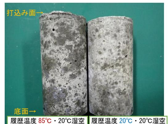
図-5 503 日における 20℃湿空環境での細骨材 A1 使用・ $K_2SO_4$  2%添加供試体の様子
