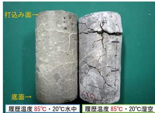
図-4 574 日における履歴温度 85℃・標準砂使用・ $K_2SO_4$  2%添加供試体の様子
