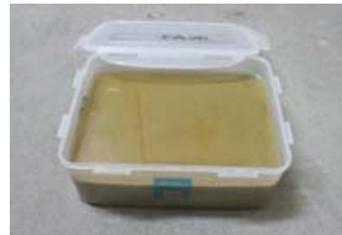
写真-2 試験体の養生方法
