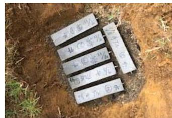
写真-3 屋外暴露試験体養生状況
