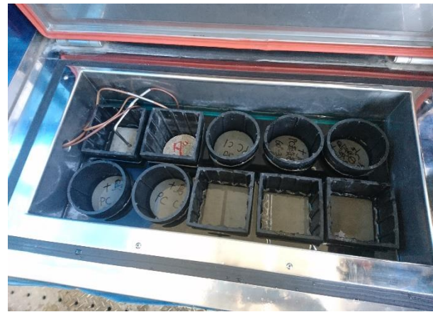
図-1 凍結融解試験槽
