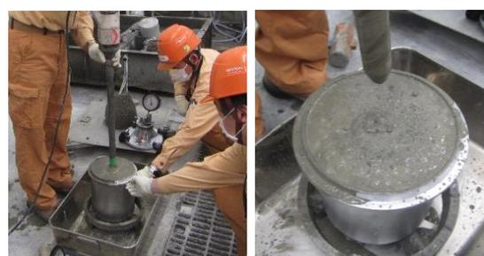
写真-1 締固め状況
