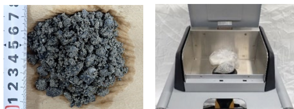
写真-3 粒状試料の測定状況 (左：粒状試料，右：専用ボックス)
