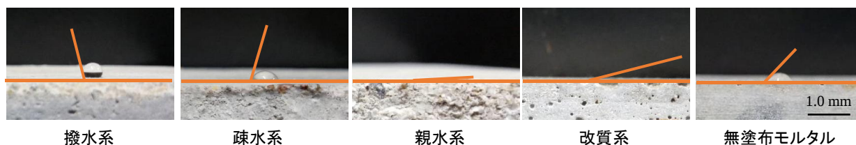
写真-1 モルタル表面へ滴下した水滴の状態
