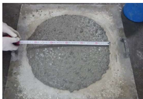
写真-2 材料分離抵抗性の確認 (H37-50)
