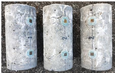
図-2 円柱供試体 材齢約3年の表面状態
