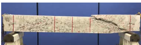
写真-1 RC梁試験体の破壊状況の一例 (R-HFC-50-EX80)
