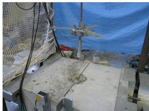
写真-5 荷重後のアンカーの様子 (M16 試験体)
