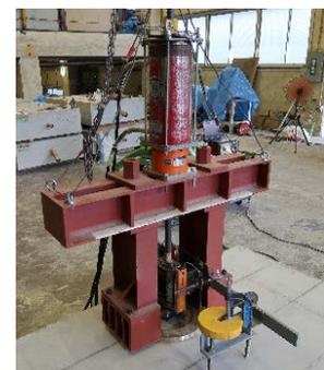
写真-2 荷重試験機全景
