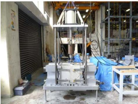
写真-4 ひび割れ試験機全景
