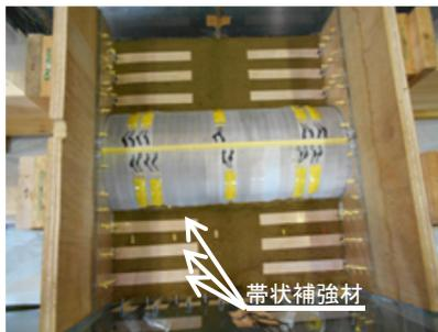
写真-8 帯状補強材の設置状況
