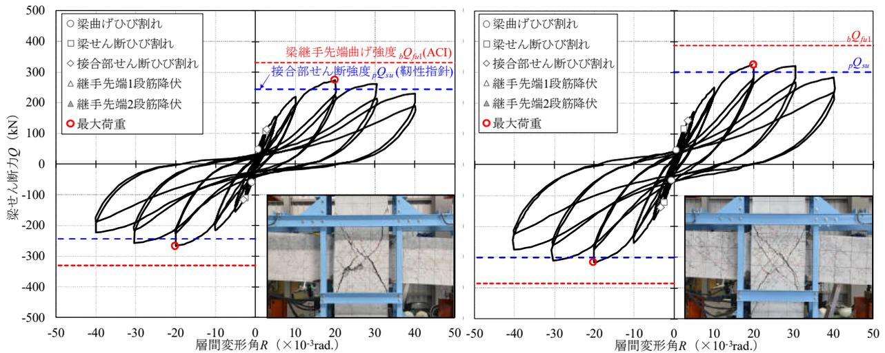
(c) TB3 : 接合部せん断破壊型・Fc27
