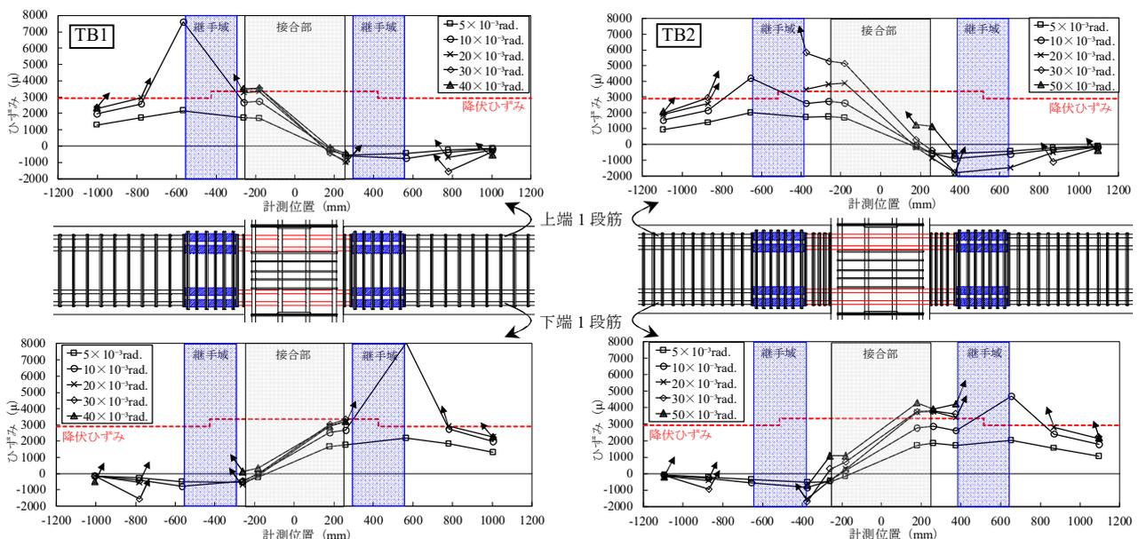
図-8 梁主筋ひずみ分布 (正加力)
