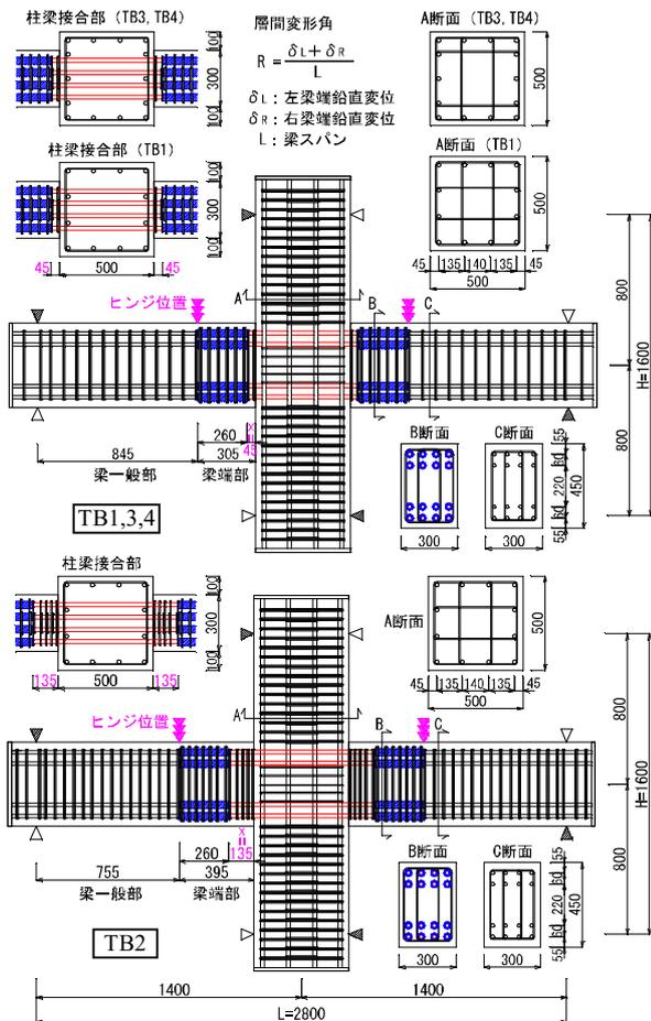
図-2 試験体形状および配筋
