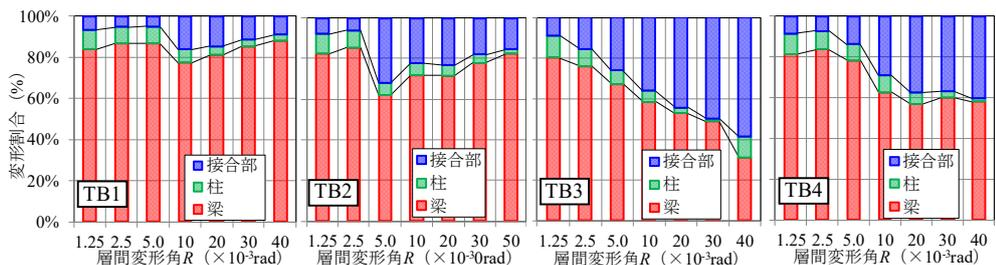
図-7 変形割合の推移 (正加力)
