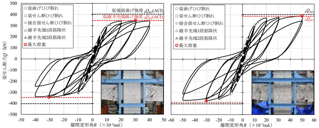
(a) TB1 : 梁 HR 曲げ破壊型・基準試験体
