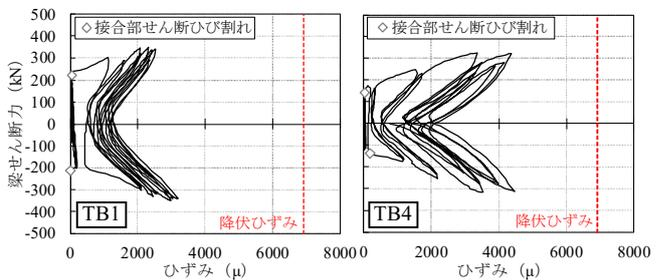
図-10 接合部の横補強筋ひずみ履歴
