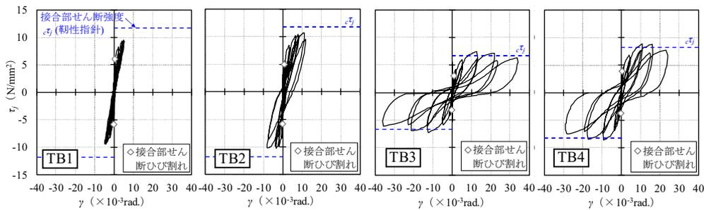
図-5 接合部せん断応力度-接合部せん断変形角関係
