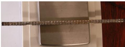
**写真-2 除錆後切断したせん断補強筋**
