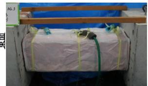
写真-1 電食中の試験体
