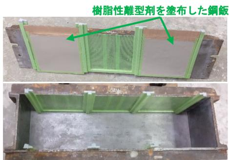
図-1 離型剤選定試験に使用した型枠
