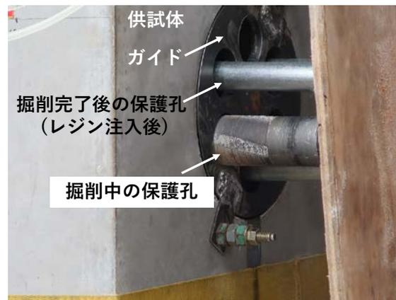
写真-2 保護孔掘削状況
