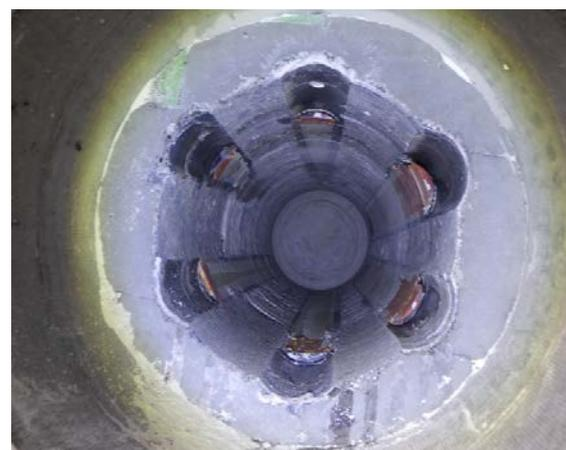
写真-4 オーバーコアリング完了後の開口部
