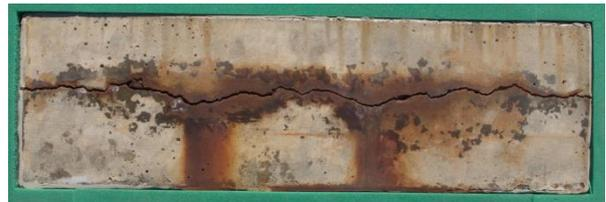
写真-3 劣化グレード II の暴露 2 年目の外観 (II-12)
