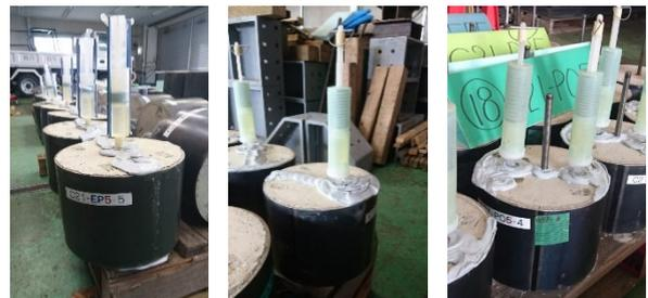
写真-1 試験体の補修状況
