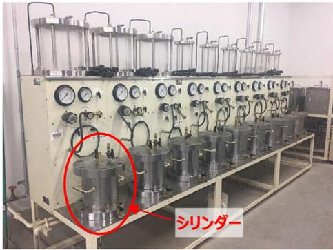
写真-1 透水試験装置の外観
