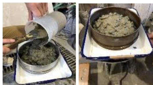
図-3 打撃ふるい分離試験状況
